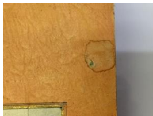
لکه‌های ناشی از نفوذ رطوبت
